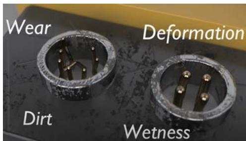
繰り返し挿抜によるピン曲がり・接触不良など、
